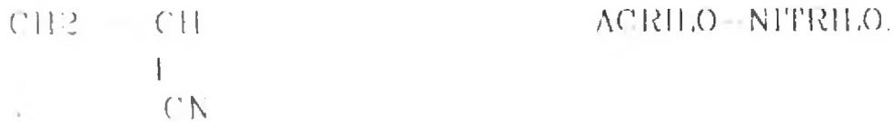
En la copolimerización del butadieno con el acrílo-nitrilo se forma el caucho nitrílico NBR.
